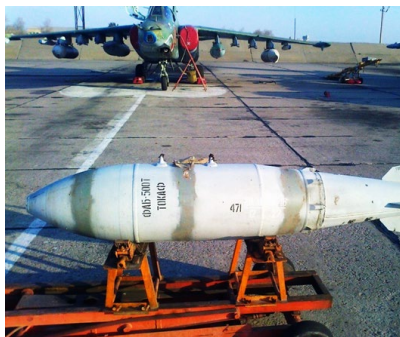
Рис. 3. Авіабомба ФАБ-500Т зі штатним спорядженням сумішшю ТОКАФ, маркування ФАБ-500Т ТОКАФ
