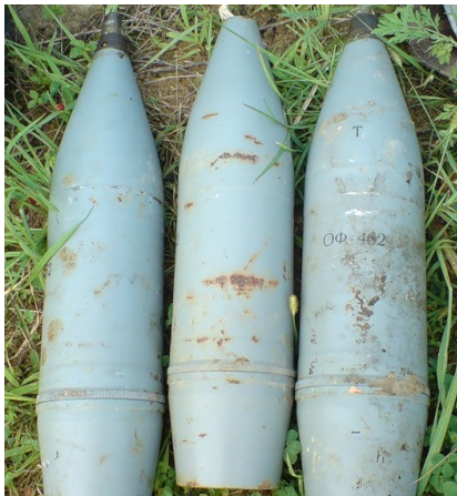
Рис. 10. Радянські 122-мм уламково-фугасні снаряди ОФ-462 зі штатним спорядженням тротилу, маркування Т ОФ-462
