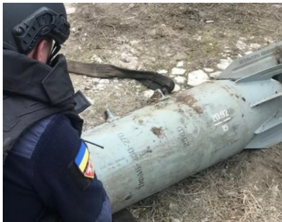
Рис. 1. Авіабомба ОФАБ-250-270, що не вибухнула у м. Торецьк, з маркуванням ОФАБ-250-270 Т
