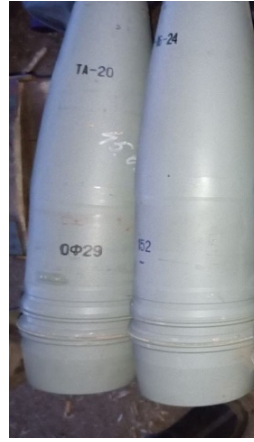
Рис. 6. Російські 152-мм уламково-фугасні снаряди ОФ29 з маркуванням ТА-20 ОФ29
